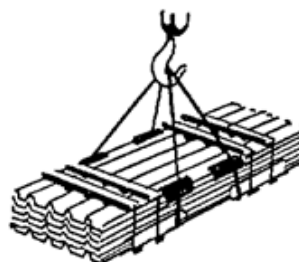
Figura 6 - Içamento de fardos inferiores a 3 metros
